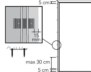
**DK:** Monteringsclipene skal fastføres med skruer, monteres 15 mm fra karmen. Afstand fra top og bund skal max være 5 cm. Derefter max 30 cm mellem hver clips.
