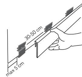
**DK:** Bunden af clipene placeres ned til gulvet, hvorefter de fastgøres. Husk at ledninger skal trækkes bag ved clipen. Afstanden fra listen ender skal max være 5 cm. Derefter placeres clipene med 30-50 cm afstand alt efter væggens underlag. Ved særligt skeve vægge bør clipene monteres tættere end 30 cm. Herefter klikkes listen på clipene.
