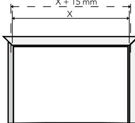
**DK:** Udregning af topgerigts længde: Mål hulmål (X) og plus med 15 mm til geringssnittet. Afmærk og lav et geringssnit på 45° i begge sider.
