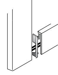
**DK:** Fodlisten afsluttes ind mod gerigten i et lige snit. Herefter isættes et PRIMO koblingsstykke, som giver perfekt afslutning. Husk at medregne clipen når du mål længden. Afslutter fodlisten mod andre gerigtyper, afgøres snittet efter pågældende gerigt.
