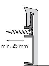
**DK:** Monteringsclipene skal fastgøres med skruer. Brug minimum 35 mm skruer, samt skruer og ravplugs der passer til væggens byggemateriale. Skruerne må ikke spændes for hårdt.
