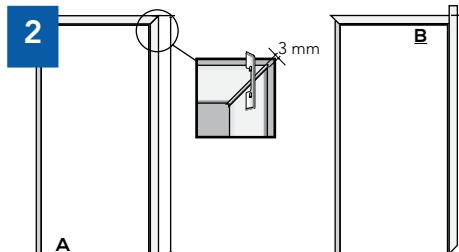
**DK:** Målene på sidegerigten beregnes sådan: Lav et geringssnit på 45° i den ene ende (A). Vend derefter gerigten på hovedet med spidsen mod gulvet. Sæt et mærke der, hvor gerigten er ud for overkanten på øverste gerigt og lav et lige snit ved mærket (B). Husk at frægne 3 mm til geringssamlingen.
